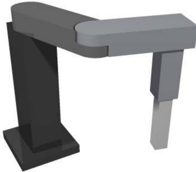
Figura 3.16– Robô com articulação horizontal SCARA.
